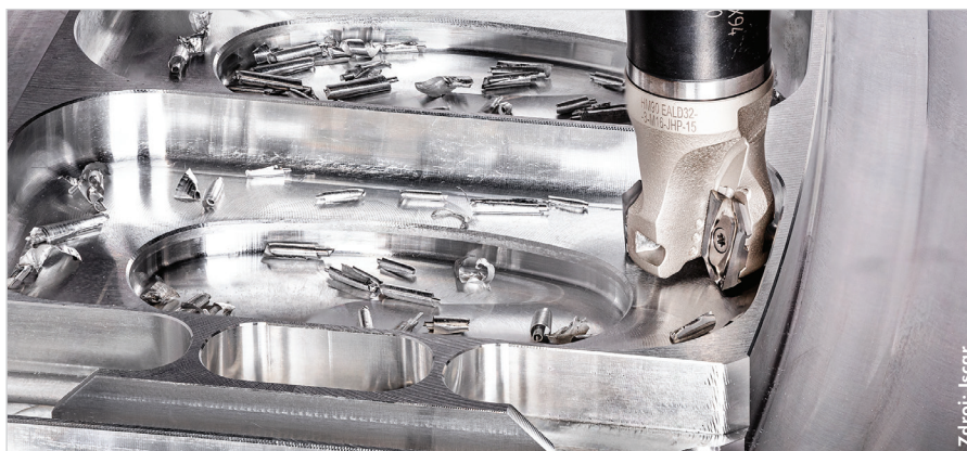
Obr. 2. Devadesátistupňová frézovací hlavice HM90 EAL D32-3-M16-15-JHP systému FlexFit s kanálky pro vysokotlaké chlazení JHP a vyústěním chladiva ke každému břítu.
