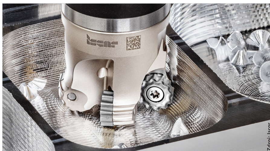
Obr. 1. Čelní nástrčná fréza FRW z řady Mill-Shred osazená kruhovou destičkou RCMT-FW s dělenou řeznou hranou v jakosti karbidu IC28 pro obrábění materiálů skupiny ISO N.
