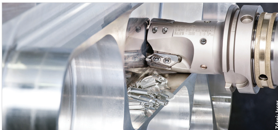
Obr. 3. Devadesátistupňová stopková fréza HSM90SFD50-3-63A/80MQL-22 s integrálním HSK, určená pro super pozitivní destičky HSM90S APCR 2207 s leštěným čelem (APMX 22 mm).
